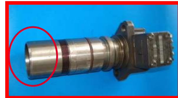
Podzespół niekompletny (brak popychacza)
